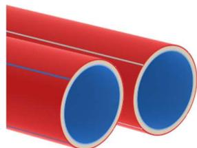
Трубы термостойкие полимерные гладкие трехслойные с внутренним слоем из полимерной композиции стойкой к воздействию короткого замыкания в кабеле. Предназначены для обустройства трубных систем для защиты силовых электрических кабелей напряжением до 500 кВ. Методы прокладки: траншейный и бестраншейный, в том числе горизонтально направленное бурение.
